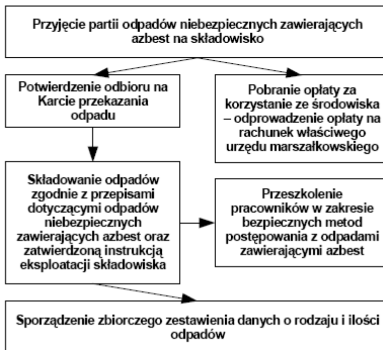
Rys. 7. Procedura dotycząca składowania odpadów na składowiskach lub w wydzielonych kwaterach przeznaczonych do wyłącznego składowania odpadów zawierających azbest
